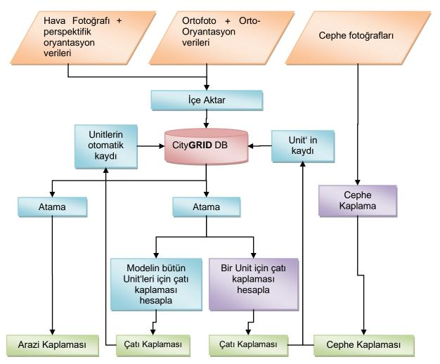
Çatı ve arazi kaplama fotoğrafı doğru oryantasyon parametreleri ile veri tabanına aktarıldıktan ve modele atandıktan sonra otomatik olarak kaplanır. Cephe kaplaması interaktiv olarak yerleştirilir.
